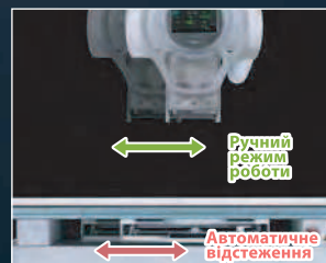
Відстеження стійки Буккі після горизонтального переміщення головки трубки (в тому числі підлогової)
